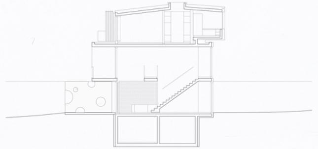
vier unsichtbare Betonscheiben im 1. Obergeschoss bilden das Tragwerk. Die Glasfront im Süden Richtung Garten wird durch die Betonwand des direkt ans Haus anschliessenden Schwimmbeckens begrenzt, hinter der sich das Arbeitszimmer verbirgt. Die bullaugenartigen Fenster (auch unter Wasser) und die eingelegten Kreise, die an Wasserblasen erinnern, entfalten ihre Wirkung vor allem im Untergeschoss, das durch seinen blauen Farbanstrich einem U-Boot ähnelt.
